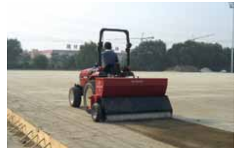
Sept 11, 2007 - le gazon olympique, pour les jeux olympiques de Pékin en août 2008, planté avec Speed-Seed, produisant 1840 trous /m 2 pour y déposer les semences.
