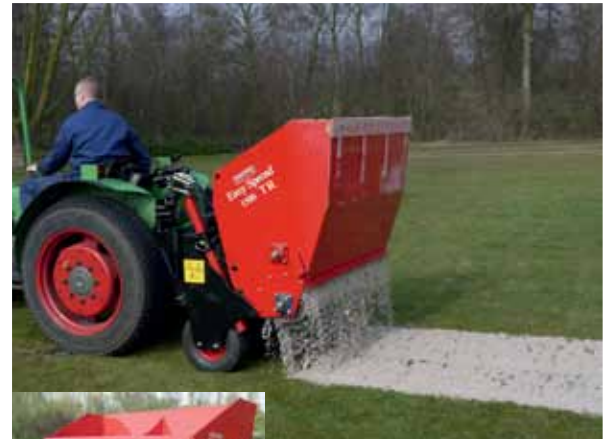
L'Easy-Spread 2000TR porte la charge sur 7 pneus.
