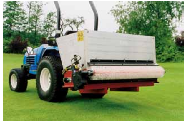
La trémie du Rink 1005 a une capacité de 0,75 m 3 .
