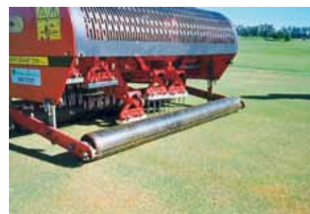
Minipointes Ø 5 mm sur des adaptateurs multipointes
