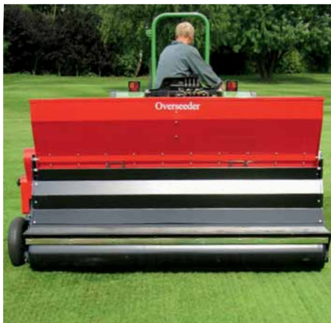
Les semences glissent entre les lames dans le sillon.
