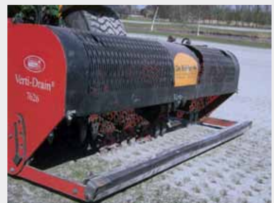
L'utilisation des pointes «fusée» est destinée uniquement pour les plus lourds modèles Verti Drain 7621 et 7626
