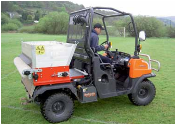
Le Rink 1003 a une trémie de capacité 0,4 m 3 .
