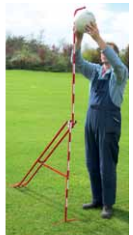
Test du rebond
