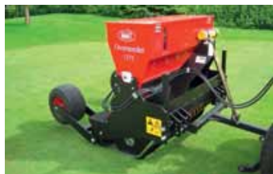
Overseeder 1275 équipé du kit de roues semi-portées en option.
