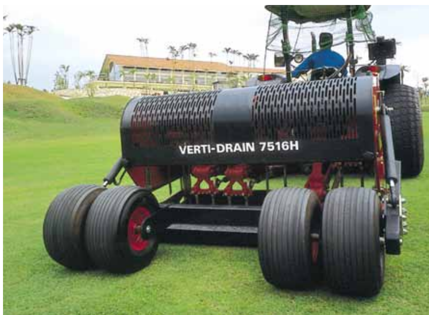
Le système de roues jumelées permet une cylindrée tracteur inférieure.
