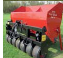
L'Easy-Spread 2000TR porte la charge sur 7 pneus.
